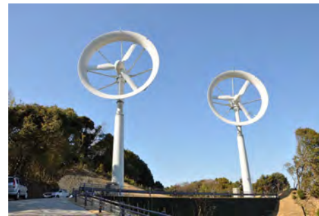
中型レンズ風車(100kW) 次世代エネルギー実証施設PJ
