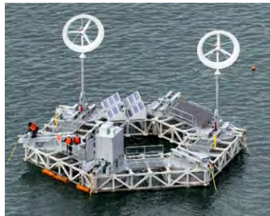
博多湾小型浮体ファーム(8kW) 環境省PJ (朝日新聞提供写真)
